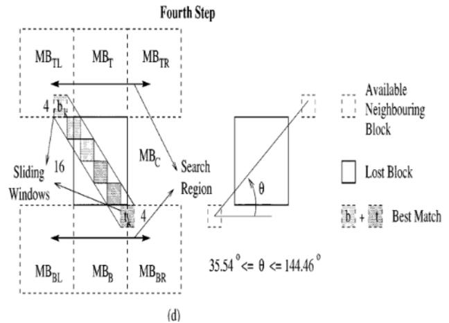
Fig. 2. Schematic presentation of the split-match algorithm.  $MB_T$ ;  $MB_B$ ;  $MB_{TL}$ ;  $MB_{TR}$ ;  $MB_{BL}$ ;  $MB_{BR}$  are adjacent to the lost one,  $MB_C$ ;  $MB$ 's.
